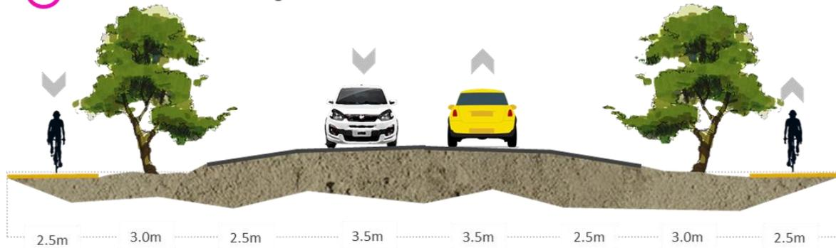
IMAGEN 106. PROPUESTA DE SECCIÓN CIRCUITO VIAL
